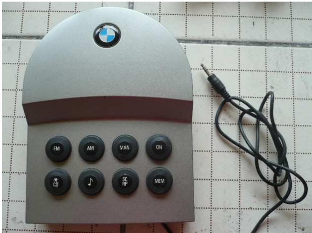
Pour ce montage, compte tenu que je n'ai pas réussi a trouver des boutons poussoir assez bas qui rentrent dans le boîtier pour pouvoir refermer correctement afin d'avoir l'étanchéité, j'ai refait la platine et ai utilisé les poussoirs existant plus le connecteur. Avantage on utilise aussi les LEDS.
