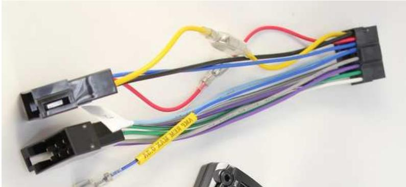
Ensuite coupez les câbles et les raccorder directement sur ceux qui sortent du "gros" connecteur BMW. Quelques point de soudure et un peu de gaine thermo-rétractable (on trouve ca chez tous les commerçant d'électronique (Conrad – Sélectronic,...))
